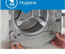
Das nachträgliche Waschprogramm, nach Herausnahme des Eises, garantiert die Hygienische Sicherheit, indem die Temperatur des Zylinders kontrolliert wird. Somit ist eine schnelle Reinigung der Maschine, bei Arbeitspausen, nicht notwendig.
